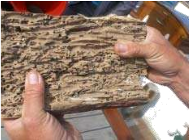
Fig. 18. Tømmer fra et bolværk ødelagt af pæleorm. (UB)
