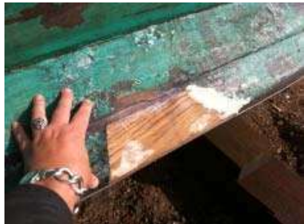
Fig. 8. Her ses, hvordan dårligt træ er erstattet af en "lus". Ved klargøringen imprægneres med Boracol. Senere smøres med trætjære.(MB)
